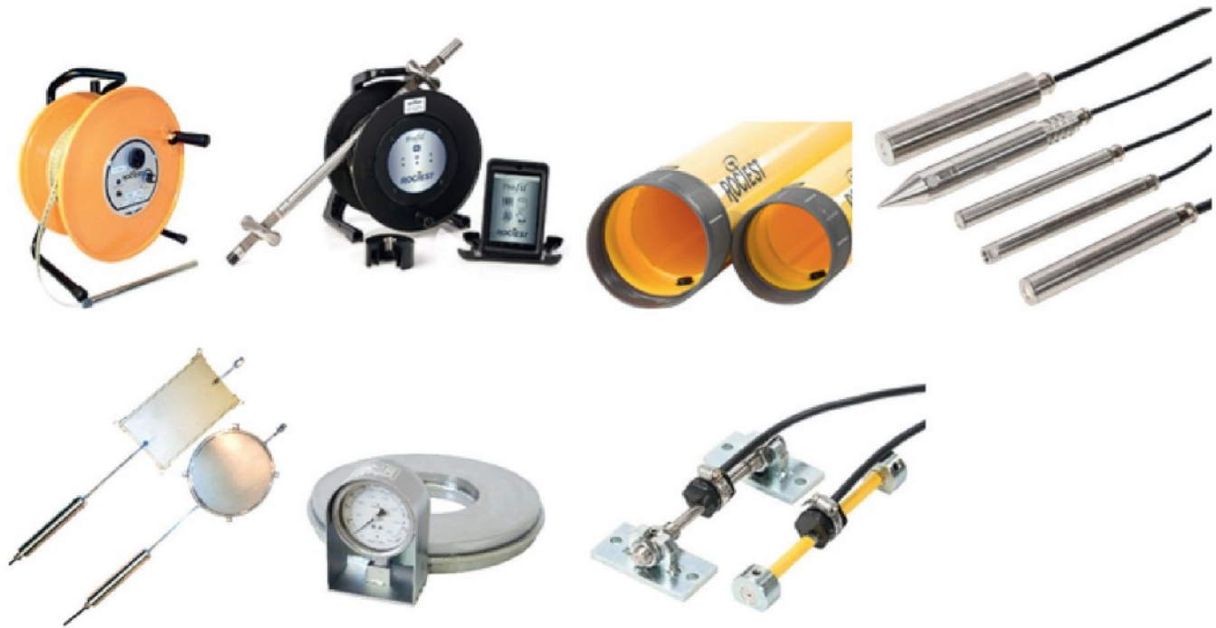
Рис. 8. Струнное и оптоволоконное оборудование для проведения мониторинга
