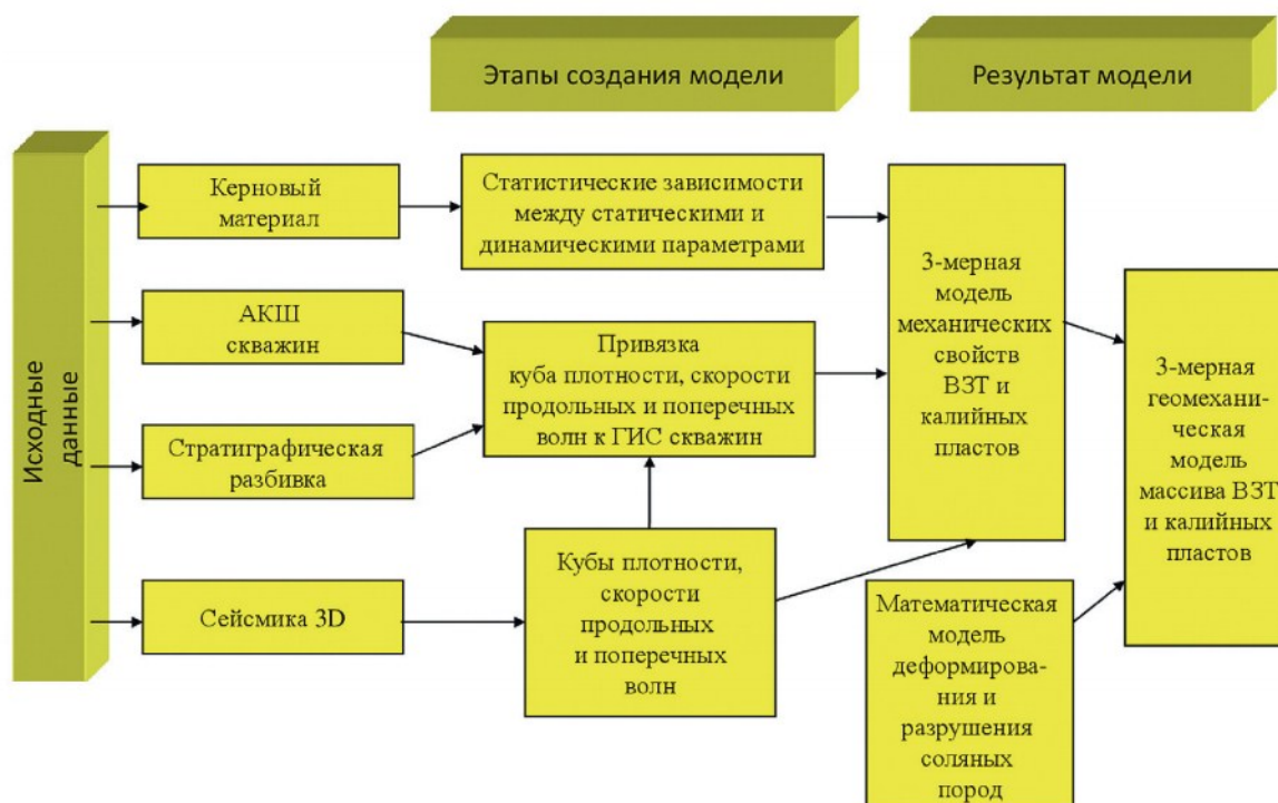
Рис. 1. Блок-схема создания геолого-геомеханической модели водозащитной толщи (ВЗТ) и калийных пластов
