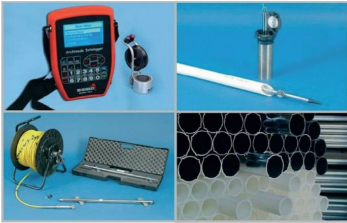
Рис. 3. Оборудование для контроля горизонтальных смещений грунта
