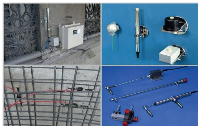
Рис. 7. Оборудование для мониторинга строительных конструкций
